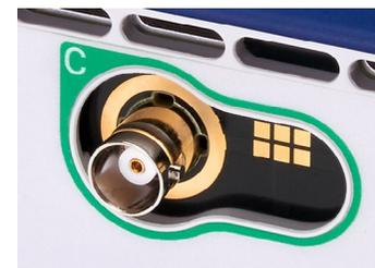
Mit einer intelligenten Tastkopfschnittstelle auf den Kanälen C bis F bei 8-Kanal-Modellen und allen Kanälen bei 4-Kanal-Modellen unterstützt die PicoScope-Serie 6000E innovative, aktive Tastköpfe mit niedrigem mechanischem Profil für eine vereinfachte Konnektivität und eine geringe Belastung des zu prüfenden Geräts.
