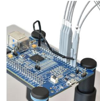
*Für Stiftleisten, bei denen die Signale zusammenliegen und nicht ausreichend Massepunkte vorhanden sind. Eine Erdungsleitung kann zum Anschluss an einen entfernten Erdungsstift am Prüfobjekt verwendet werden.*
