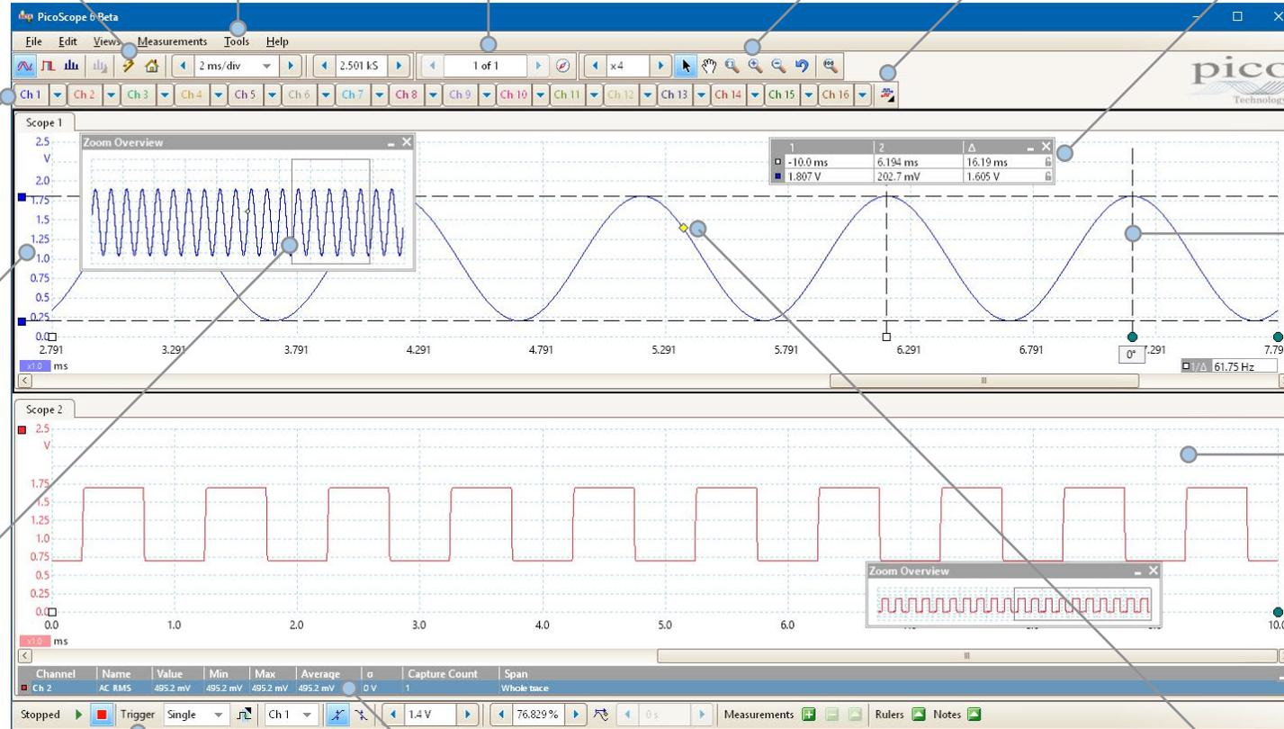
**Automatische Messungen:** Zeigen berechnete Messungen zur Störungssuche und Analyse an. Sie können in jeder Ansicht so viele Messungen wie erforderlich hinzufügen. Jede Messung umfasst statistische Parameter, die ihre Schwankungen darstellen.
